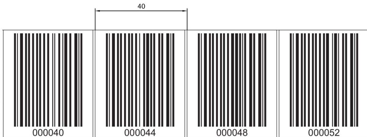
Bild 11.1: Überprüfen des Druckergebnisses BCB G40-Reparaturkit (40 mm Raster)
