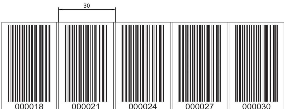
Bild 11.2: Überprüfen des Druckergebnisses BCB G30-Reparaturkit (30 mm Raster)
