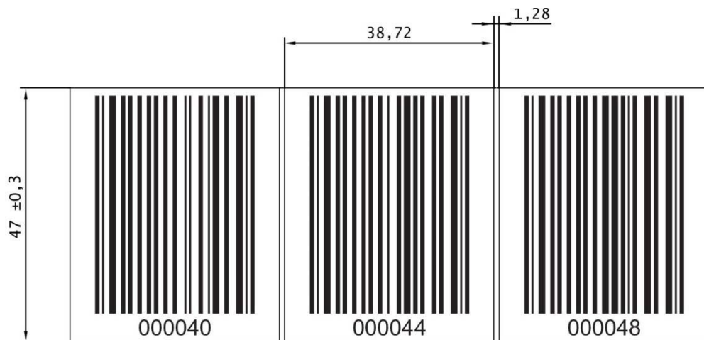
Bild 12.11: Maßzeichnung Barcodeband BCB G40 im 40 mm Raster (alle Maße in mm)
