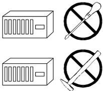
**Mechanische- oder elektrische Veränderungen** an der Achsenkassette oder den Meßsystemen **sind aus Sicherheitsgründen verboten!**
