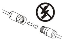
**Verdrahtungsarbeiten, Öffnen und Schließen von elektrischen Verbindungen nur im spannungslosen Zustand durchführen!**
