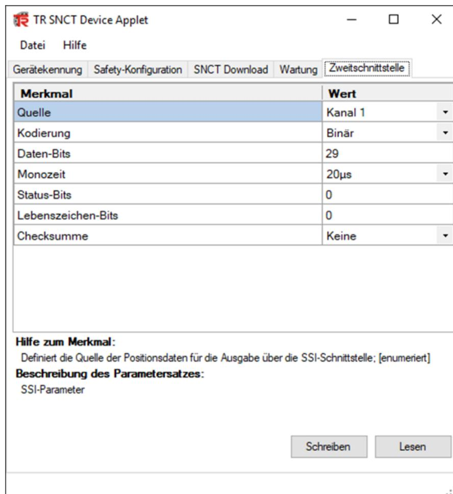
Abbildung 3: TR SNCT Device Applet Zweitschnittstelle parametrieren
