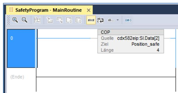
Nach einem erneuten Download des Projektes können jetzt die Positionsistwerte in den Steuerungs-Tags betrachten werden. Hierbei muss der Schlüsselschalter nach dem Download auf RUN gestellt werden!:
