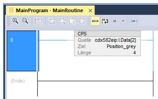
Für den sicheren Istwert muss die bereits vorhandene sichere Main-Routine unter Tasks/SafetyTask/SafetyProgram/MainRoutine um folgende Zeile erweitert werden:
