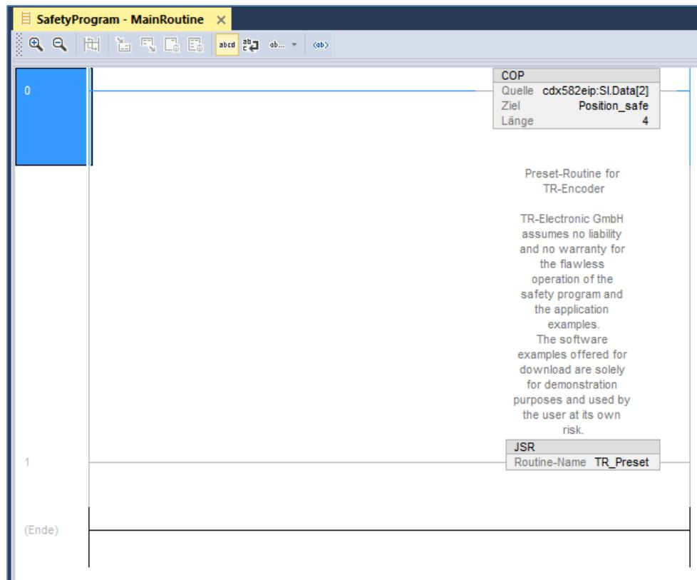
Im Anschluss wird das Projekt gespeichert und erneut heruntergeladen. Hierbei muss sich der Schlüsselschalter in Stellung PROG befinden.
