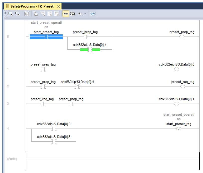
Der Preset-Ablauf kann nur durchgeführt werden, wenn die sichere Eingangsverbindung und die sichere Ausgangsverbindung projektiert und aufgebaut sind (Executing).
